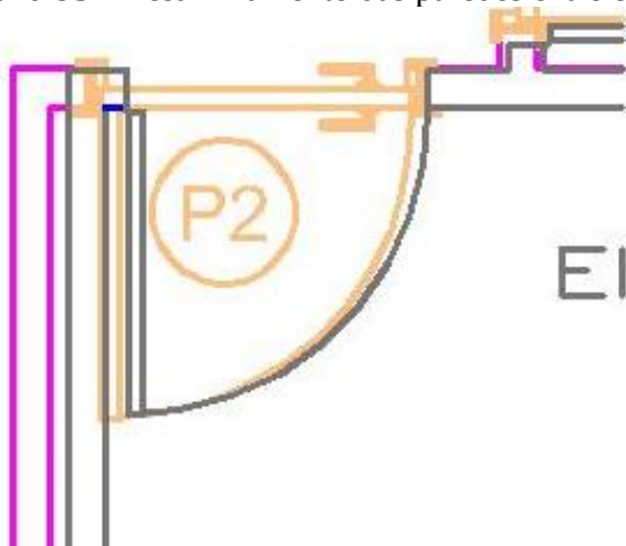
Figura 95 - Desalinhamento das paredes entre os projetos.
