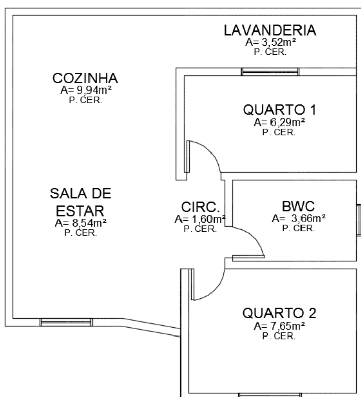
Figura 17: Planta baixa das residências.
