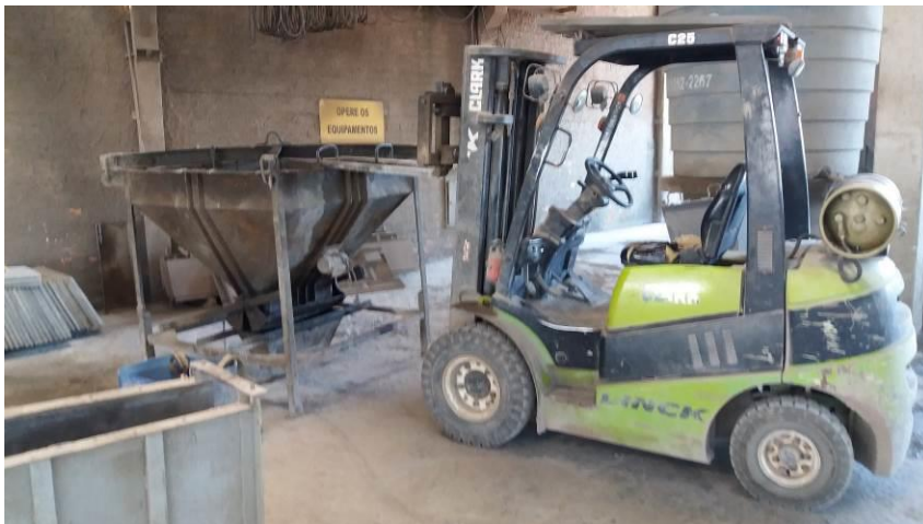
Figura 10: Empilhadeira que faz o transporte do concreto
