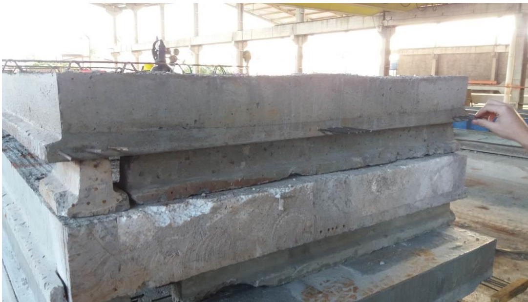
Figura 04: Pré-laje Protendida (PLP)
