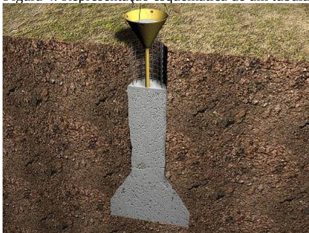
Figura 4: Representação esquemática de um tubulão em execução
