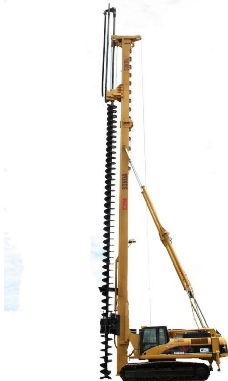
Figura 15: Equipamento para execução de hélice contínua
