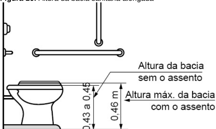
Figura 16: Altura da bacia sanitária alongada
