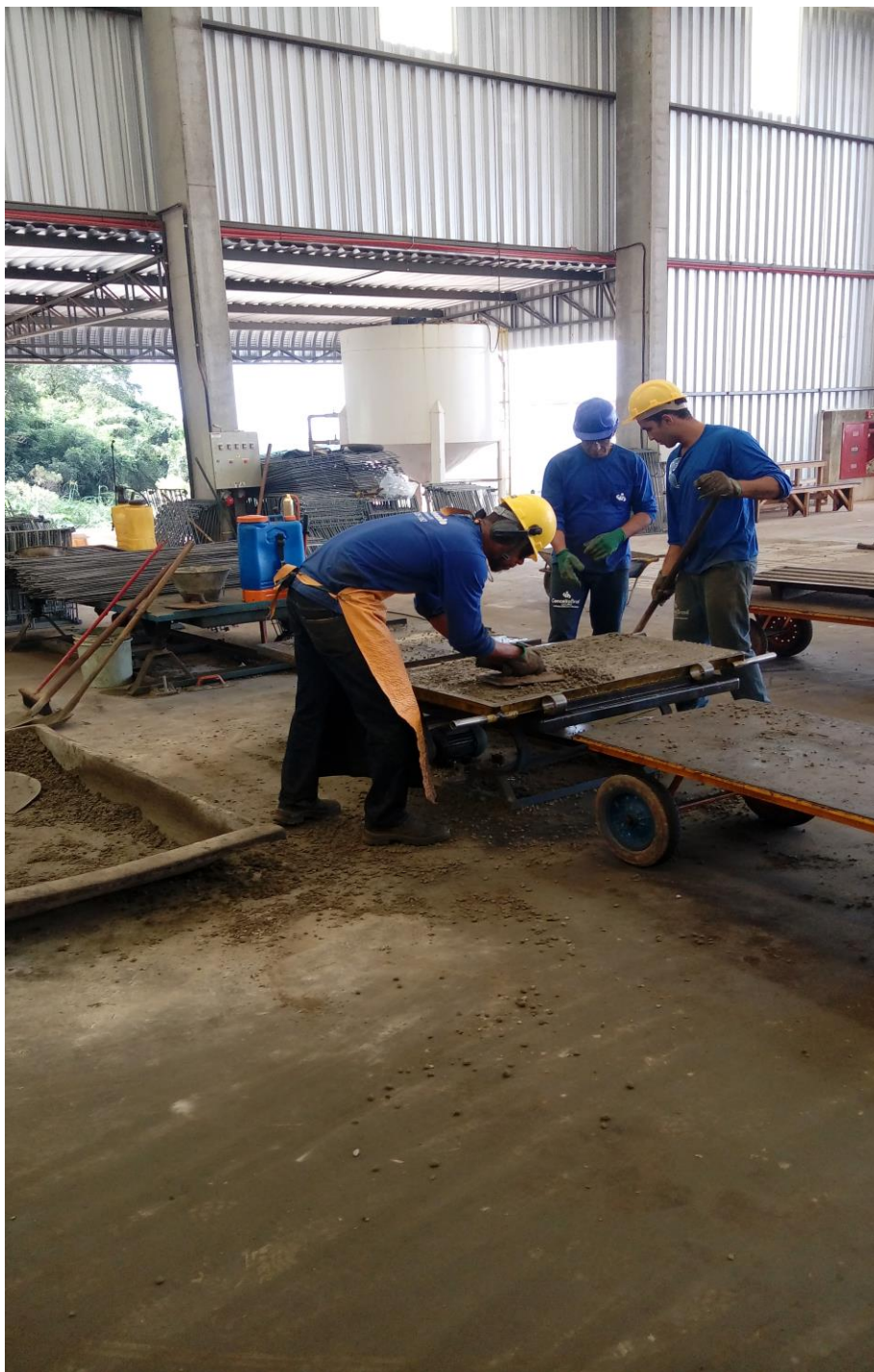
Figura 5 – Acabamento do material dentro da forma
