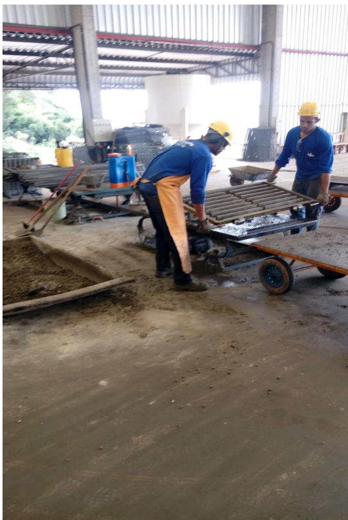
Figura 3 - Transporte da forma até a plataforma vibratória.
