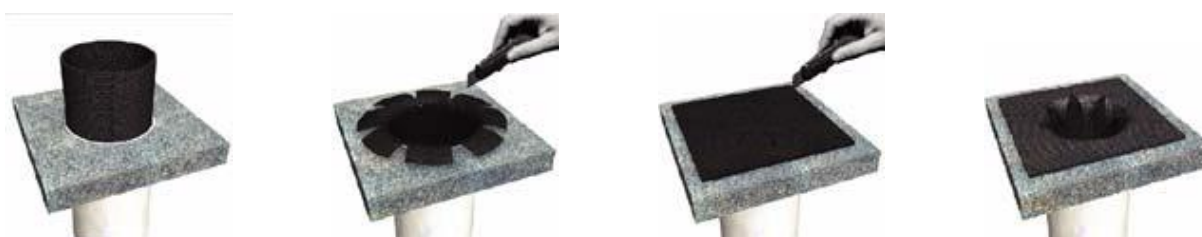
Figura 7: Impermeabilização ralo com manta asfáltica.
