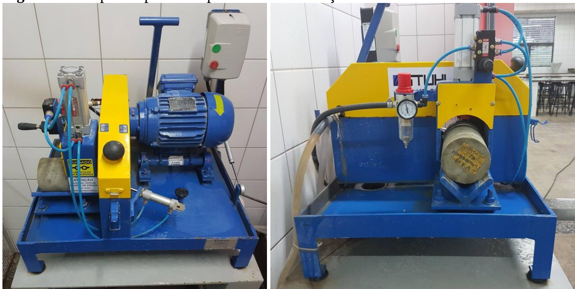
Figura 18: Corpos de prova em processo de retificação
