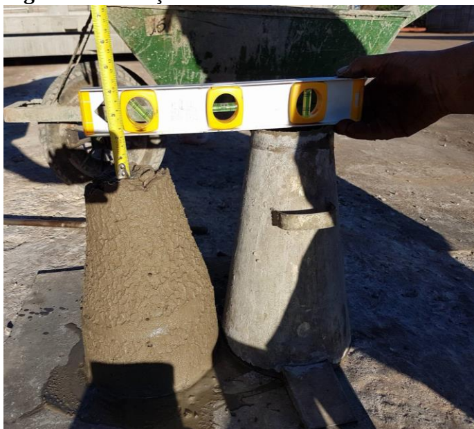
Figura 23: Medição do abatimento do concreto da Série 1
