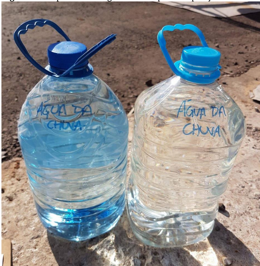
Figura 4: Recipientes com água da chuva para composição da mistura
