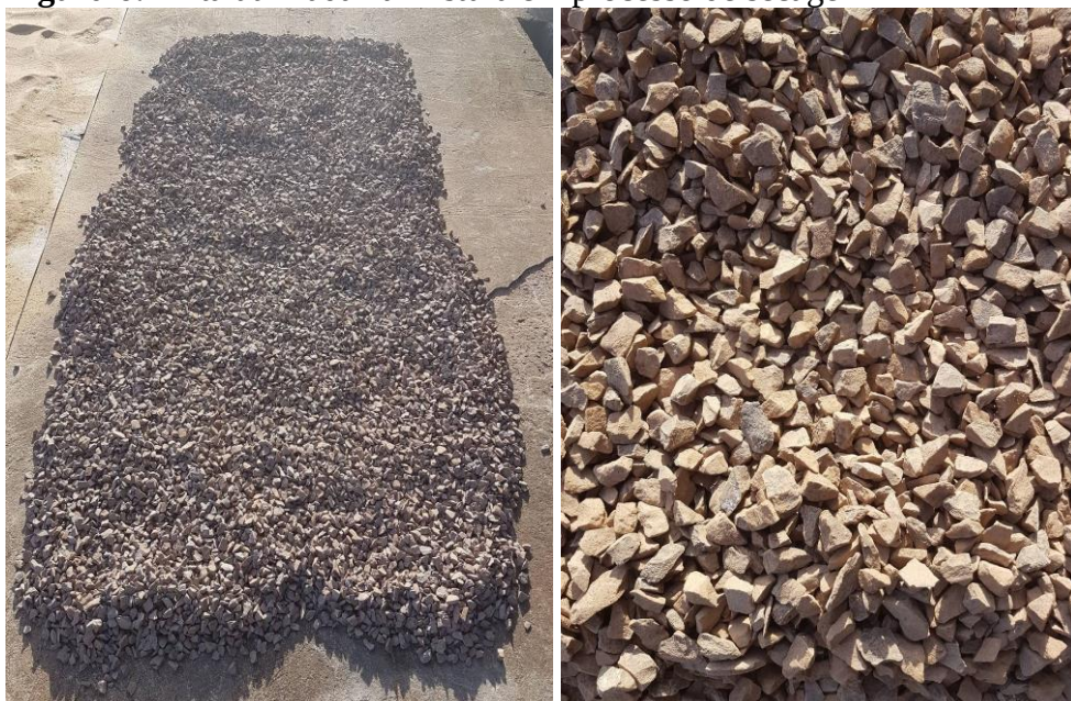
Figura 6: Brita utilizada na mistura em processo de secagem
