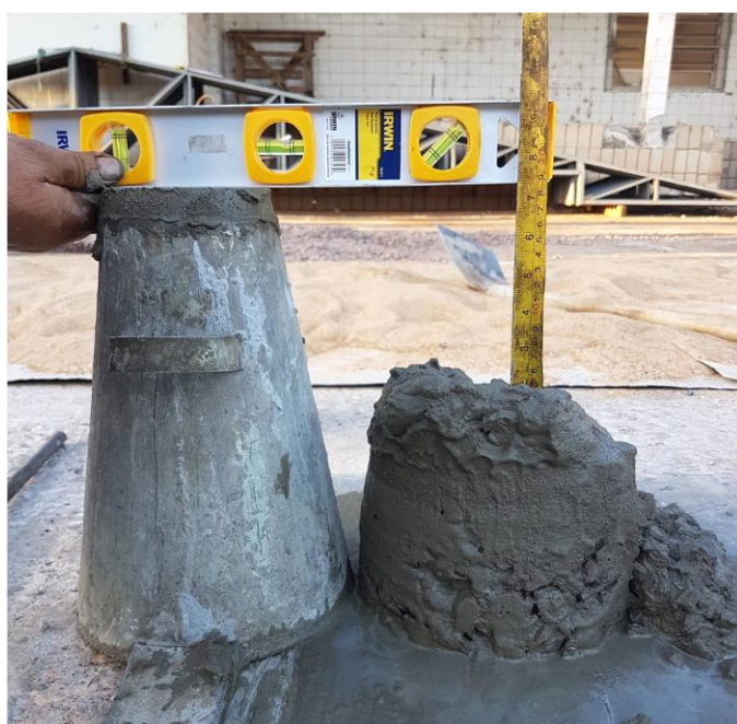
Figura 24: Medição do abatimento do concreto da Série 2
