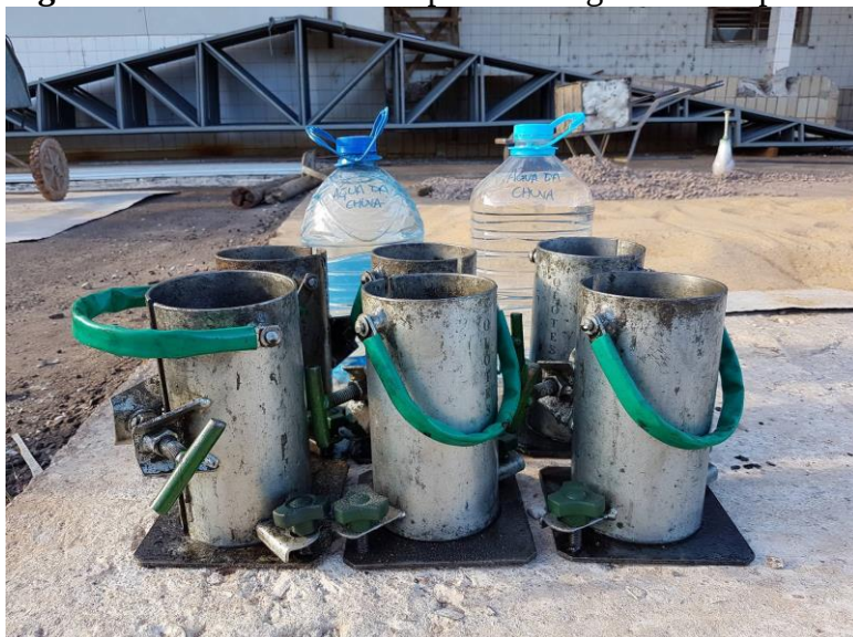
Figura 9: Fôrmas cilíndricas para moldagem dos corpos de prova
