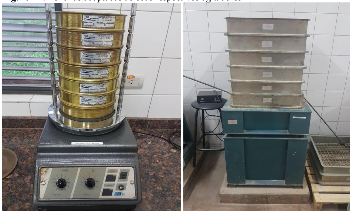
Figura 12: Peneiras adaptadas ao seus respectivos agitadores
