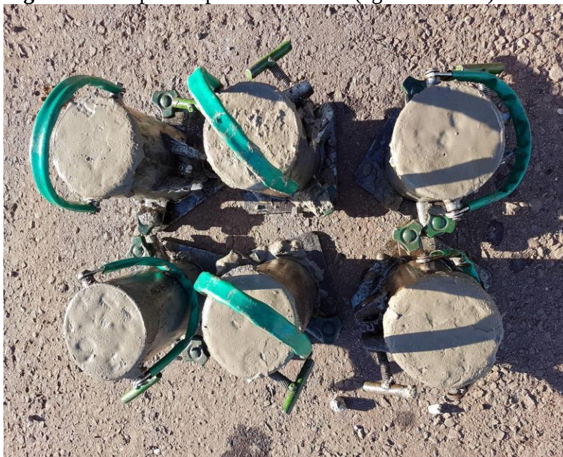
Figura 10: Corpos-de-prova da Série 1 (água da chuva)
