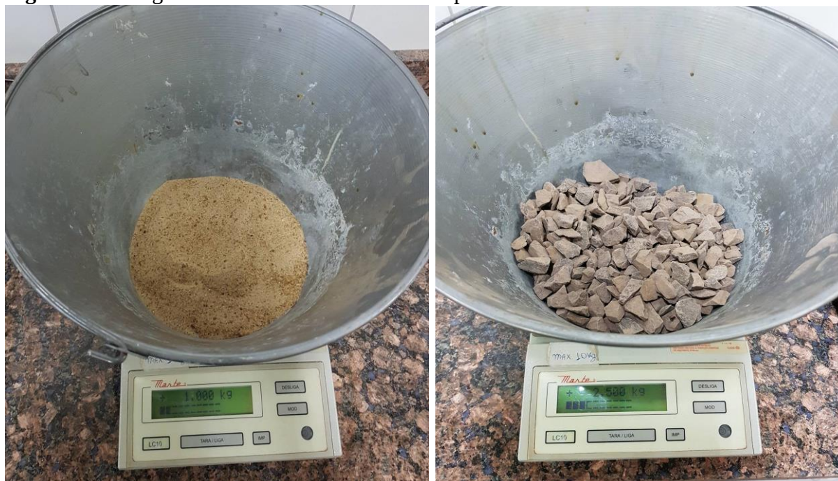
Figura 11: Pesagem das amostras de areia e brita para ensaio
