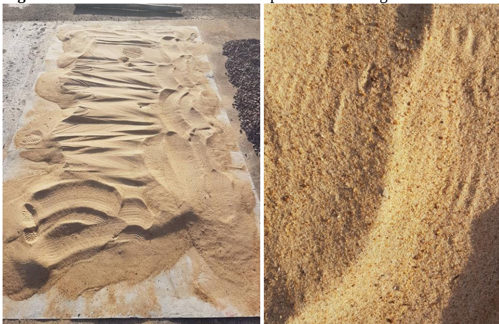
Figura 5: Areia utilizada na mistura em processo de secagem
