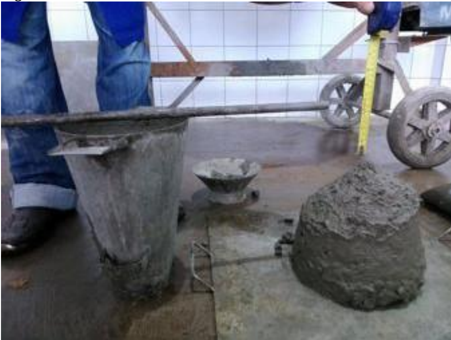
Figura 15 – Abatimento concreto com PET
