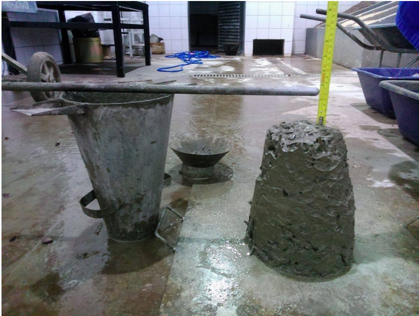
Figura 14 – Abatimento concreto sem PET
