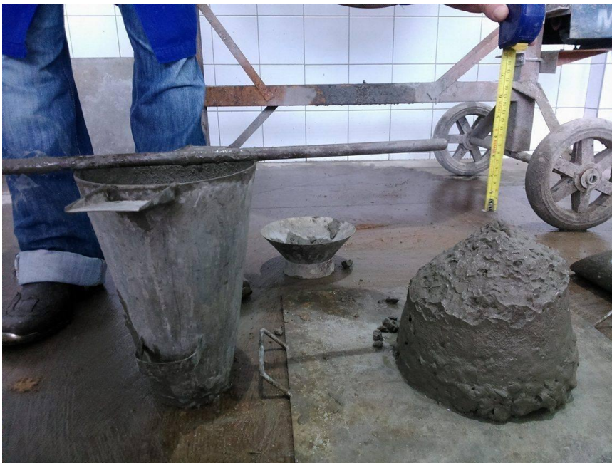
Figura 6 - Abatimento do concreto convencional
