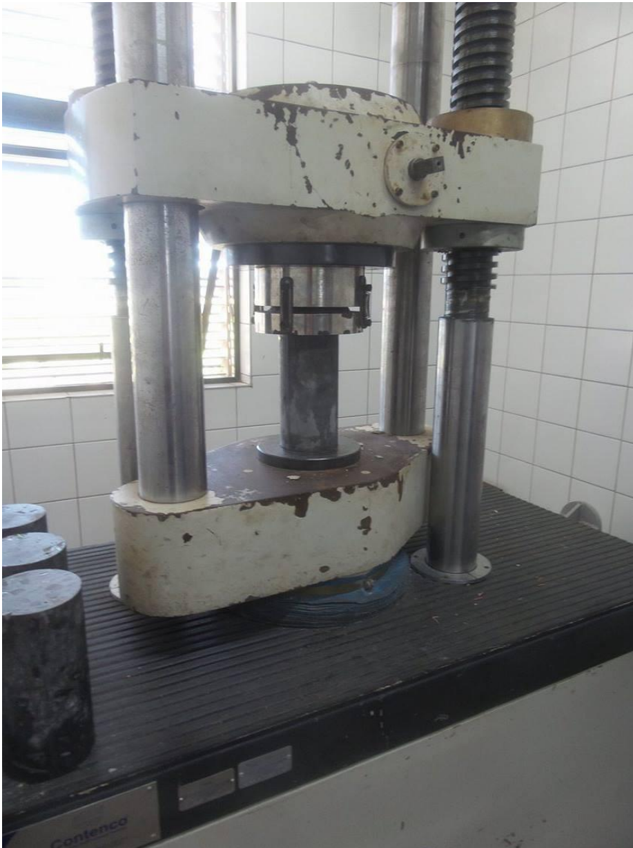
Figura 12 - Corpo de prova na prensa hidráulica para ensaio de compressão
