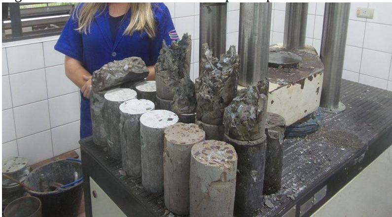
Figura 19 - Cisalhamento total dos corpos de prova.
