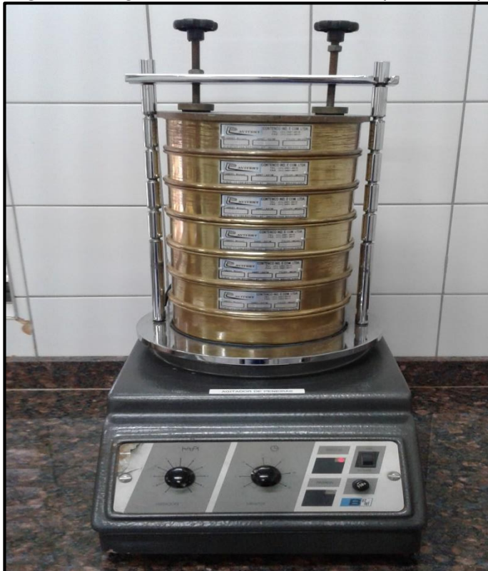
Figura 3: Agitador mecânico com as peneiras posicionadas.
