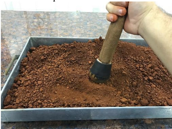
Figura 13: Destorroamento do material com auxílio de soquete.
