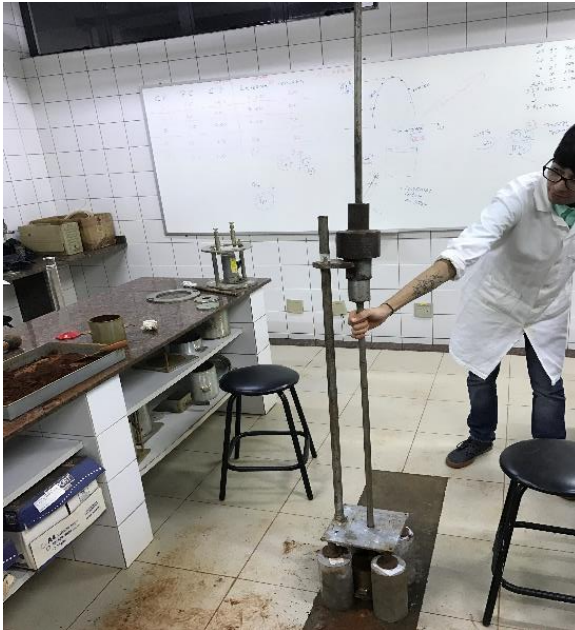
Figura 20: Ensaio CPD sendo executado
