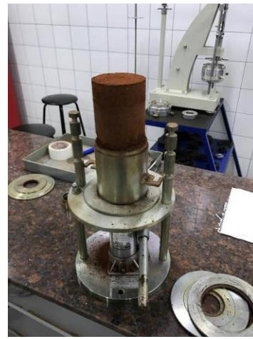
Figura 16: Corpo de Prova sendo extraído com auxílio do extrator
