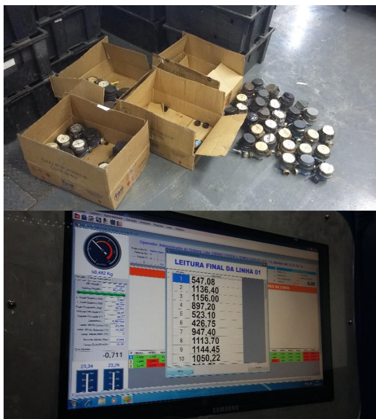
Figura 3: Amostra para ensaio e resultado demonstrado pelo software da bancada
