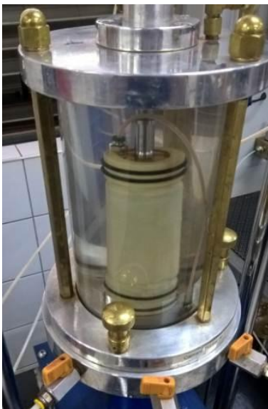
Figura 12: Corpo de prova dentro de câmara de compressão posicionada na prensa triaxial
