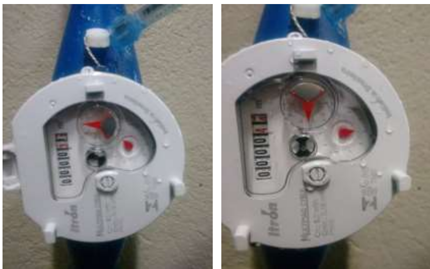
Imagem 5: Valores de vazão registrados no hidrômetro
