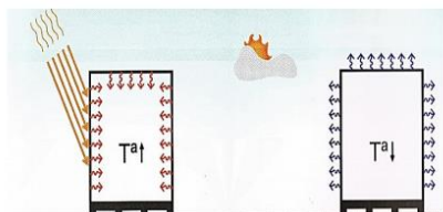
Figura 1 - Aquecimento rápido durante o dia do container com a radiação solar e resfriamento rápido durante a noite
