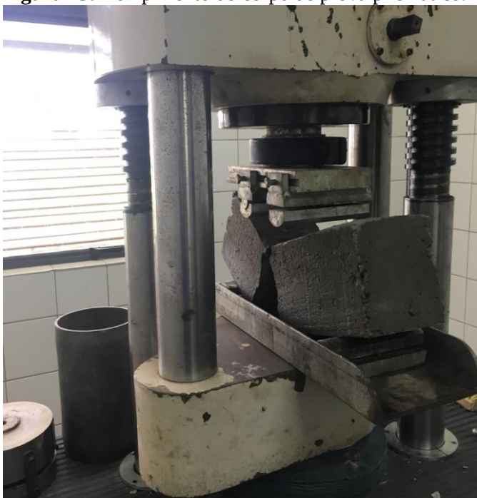
Figura 15: Rompimento do corpo de prova prismático.
