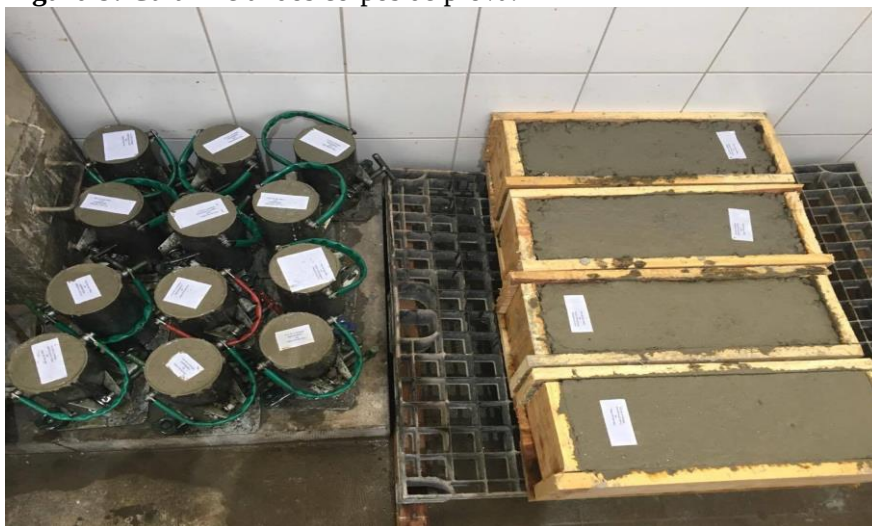
Figura 9: Cura inicial dos corpos de prova.
