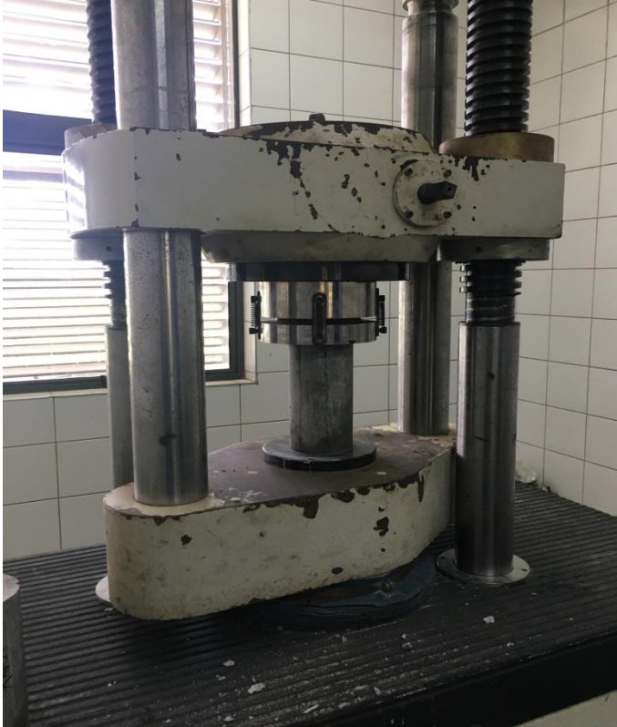
Figura 11: Corpo de prova cilíndrico entre os pratos de aplicação de carga.
