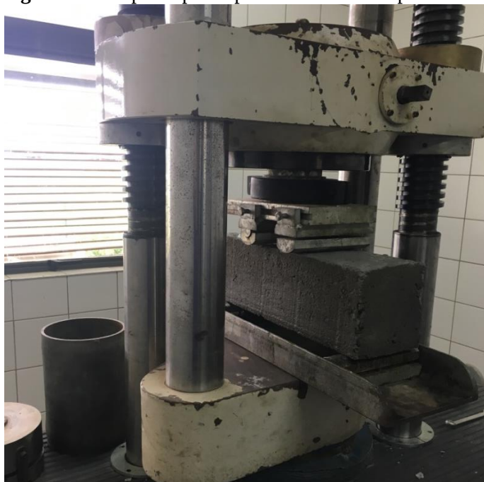
Figura 14: Corpo de prova prismático entre os pratos de aplicação de carga.
