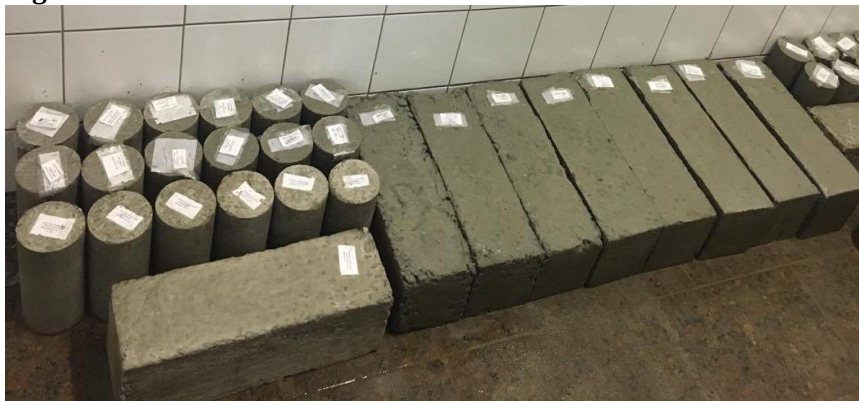
Figura 10: Concreto na câmara úmida.
