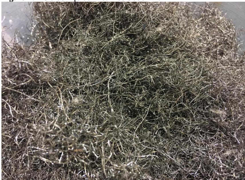
Figura 7: Fibra de Aço de Pneu Reciclado R-I.
