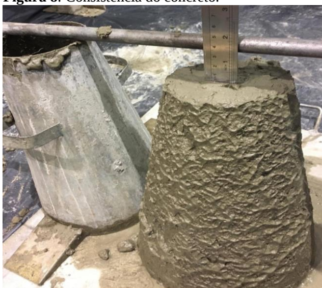
Figura 8: Consistência do concreto.
