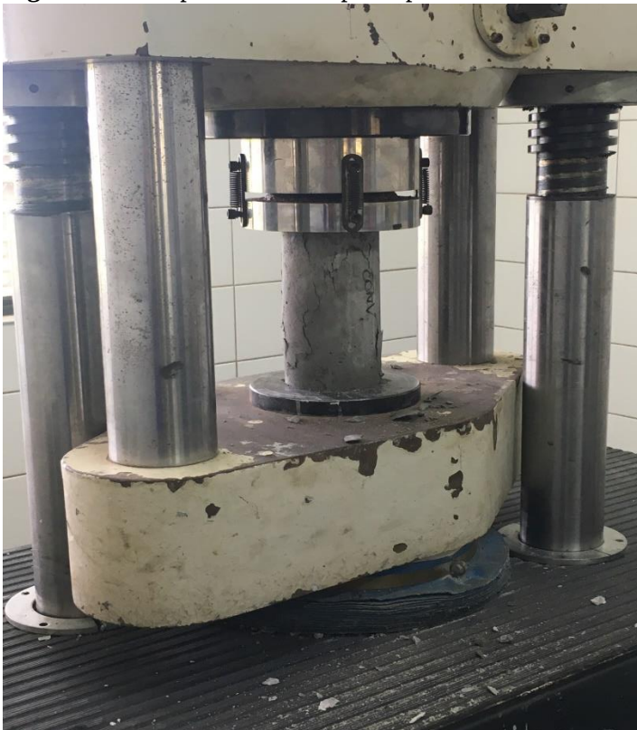
Figura 12: Rompimento do corpo de prova cilíndrico.
