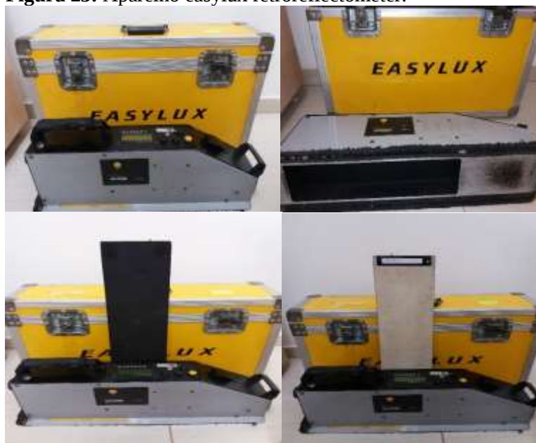
Figura 23: Aparelho easylux retroreflectometer.
