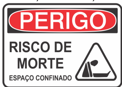
Figura 2 – Sinalização de identificação de espaço confinado
