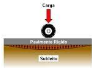
Figura 1: Distribuição das cargas no pavimento rígido:
