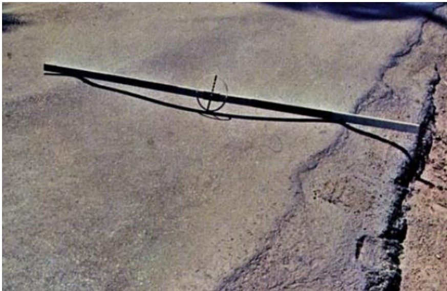
Figura 5: Coleta de dados do pavimento em trilha de roda:
