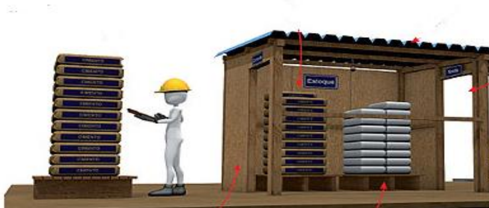
Figura 10: Exemplo de armazenamento do cimento e da argamassa.
