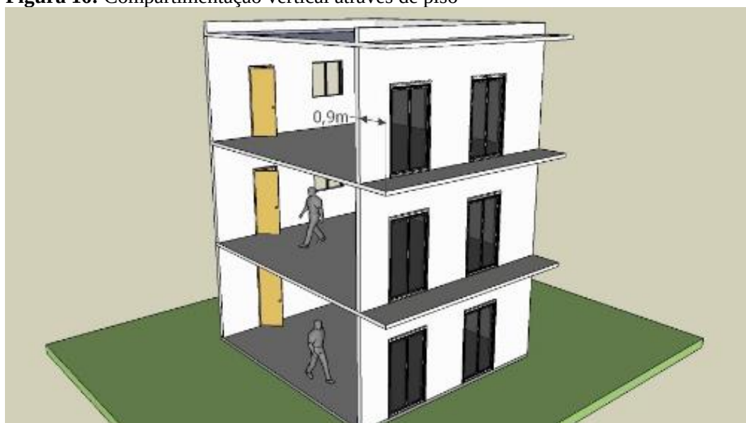
Figura 16: Compartimentação vertical através de piso
