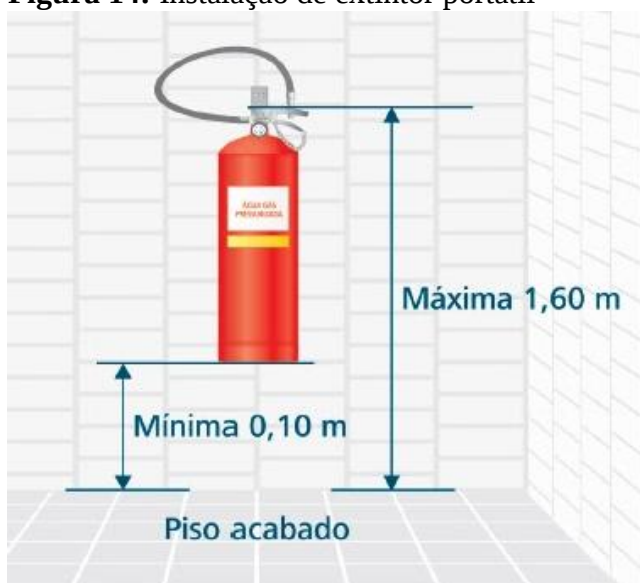
Figura 14: Instalação de extintor portátil
