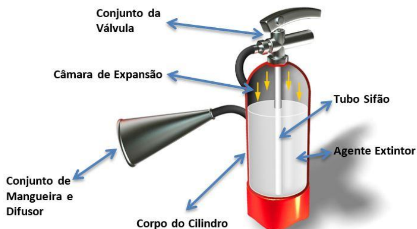
Figura 13: Componentes do extintor
