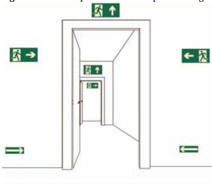
Figura 06: Sinalização de saída sobre portas e vergas de portas
