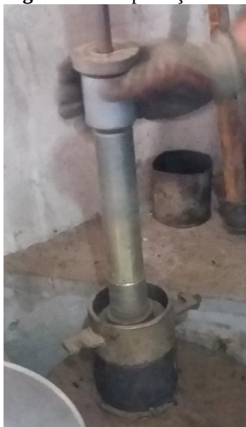
Figura 8: Compactação do corpos de prova
