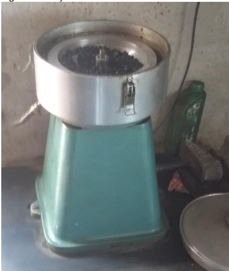
Figura 4: Extração do betume através do Rotarex
