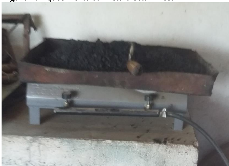
Figura 7: Aquecimento da mistura betuminosa
