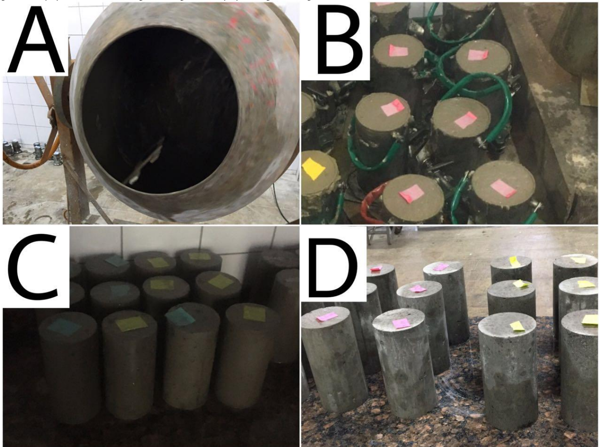
Figura 5: Moldagem dos corpos de prova; (A) Mistura do concreto; (B) Moldagem dos corpos de prova; (C) Cura dos corpos de prova; (D) Corpos de prova curados e retificados.
