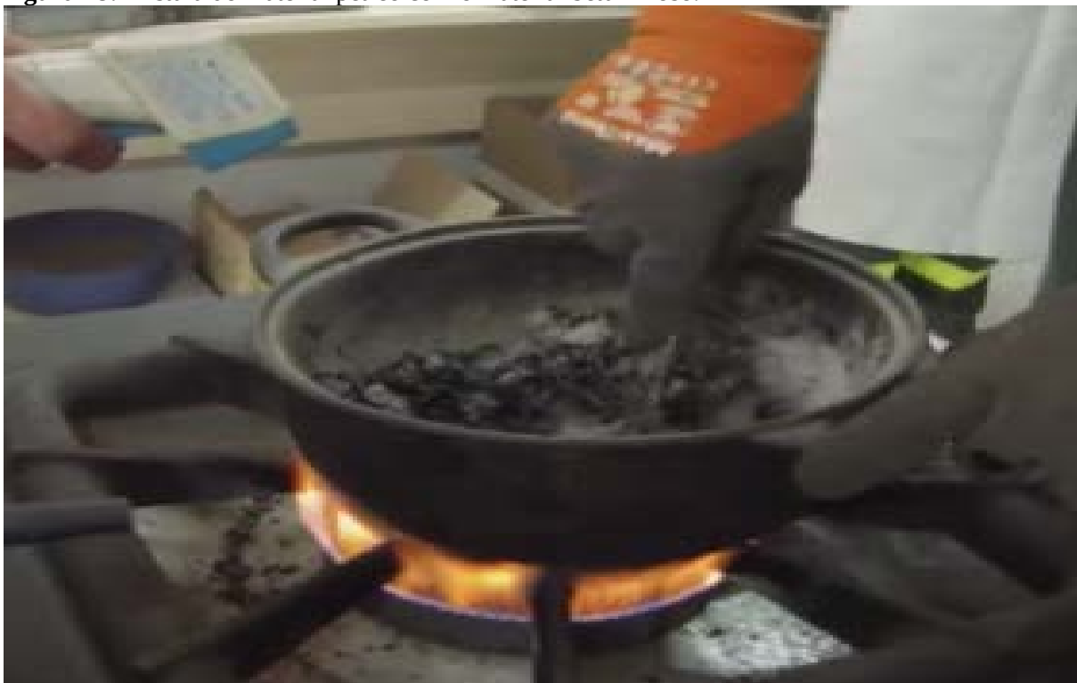
Figura 18: Mistura do material pétreo com o material betuminoso.
