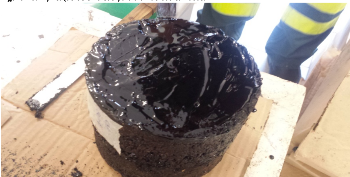
Figura 20: Aplicação de emulsão para a união das camadas.
