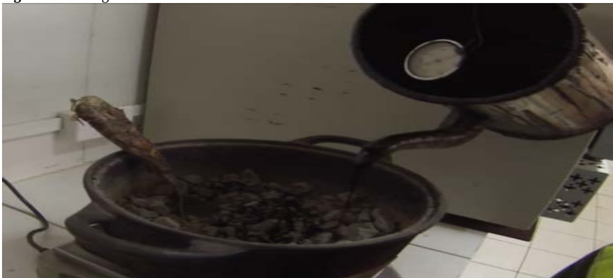
Figura 17: Dosagem do concreto asfáltico.
