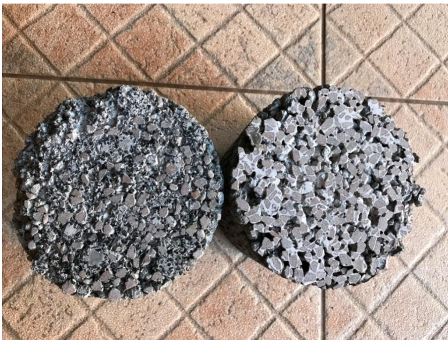
Figura 14: Vista superior dos corpos de prova - Na esquerda com substituição de borracha e na direita convencional.
