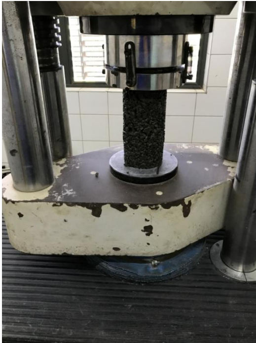
Figura 11: Rompimento do corpo de prova convencional.
