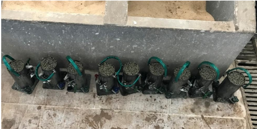
Figura 8: Corpo de prova sem adição de borracha dentro dos moldes.
