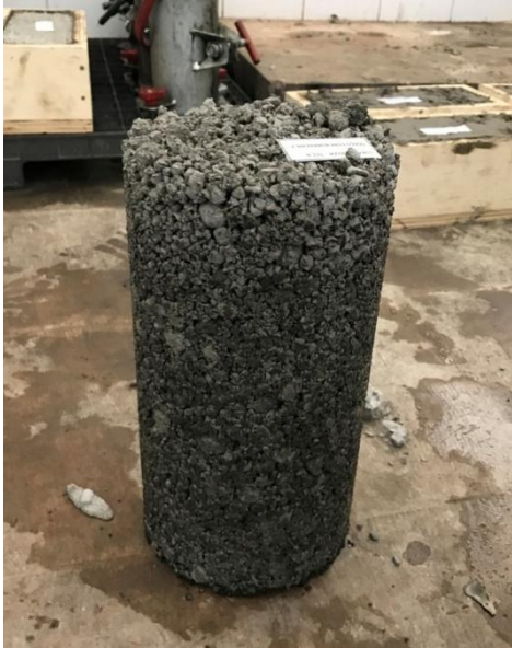
Figura 10: Corpos de prova com adição de borracha desmoldado e etiquetado.
