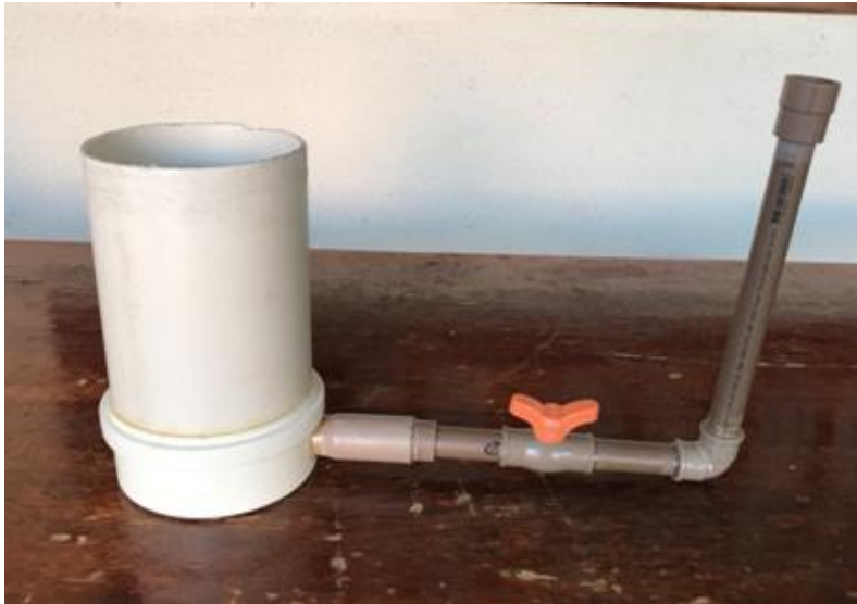
Figura 15: Aparelho para realização do ensaio de permeabilidade sem o reservatório.
