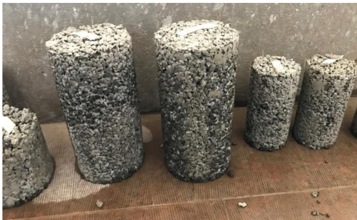
Figura 9: Corpos de prova convencional desmoldados e etiquetados.
