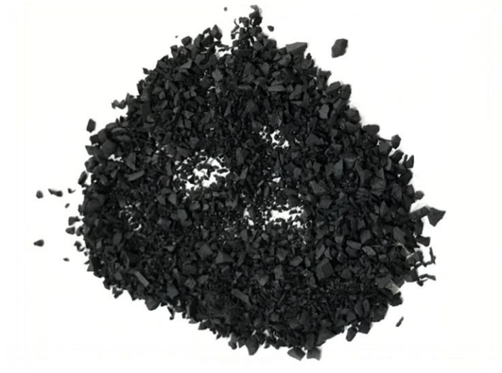
Figura 6: Resíduos de borracha de pneus inservíveis triturado.
