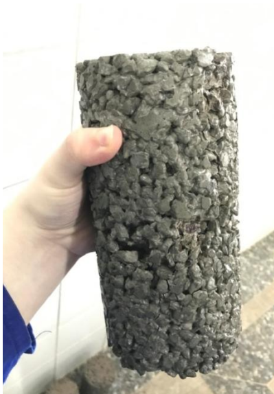
Figura 17: Corpo de prova convencional rompido.
