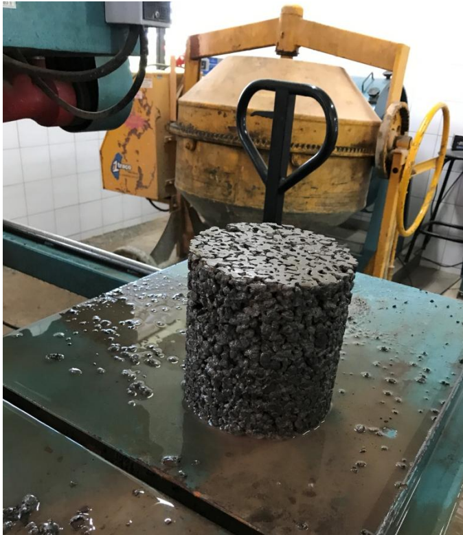
Figura 13: Corpo de prova serrado para realização de ensaio de permeabilidade.
