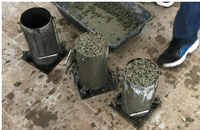
Figura 7: Moldagem do corpo de prova.
