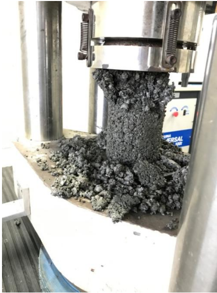
Figura 18: Corpo de prova com adição de borracha rompida.
