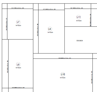
DETALHAMENTO ARMADURAS POSITIVAS PAV. SUPERIOR esc. 1:25
