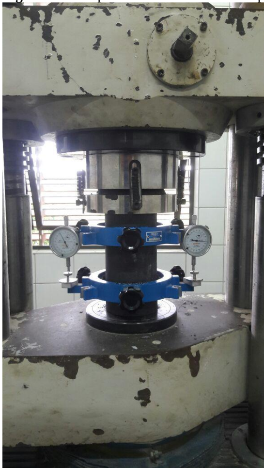
Figura 27: Compressômetro com bases independentes, com dois anéis fixados no corpo de prova.
