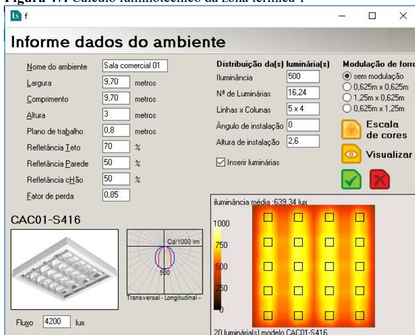
Figura 47: Cálculo luminotécnico da zona térmica 1
