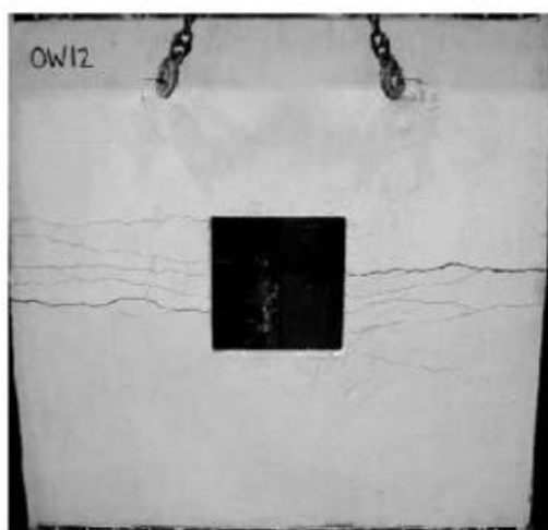
Figura 13: Fissuras em parede com ações em uma direção.
