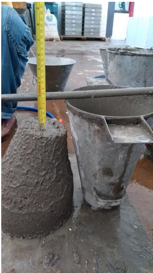
Figura 12: Medição do slump test 1.
