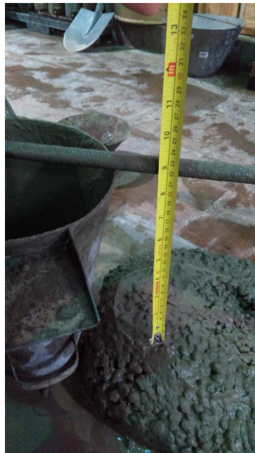
Figura 13: Medição do slump test 2.
