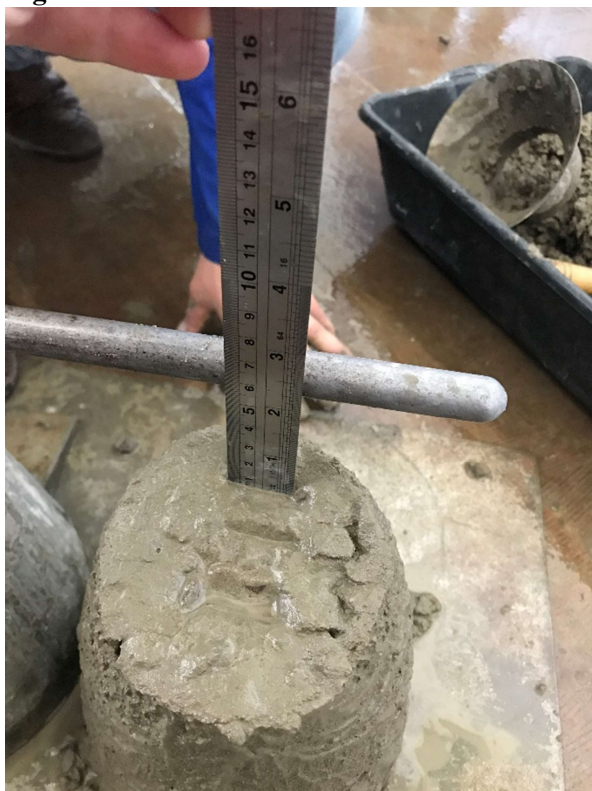
Figura 5- Ensaio de abatimento do tronco de cone.
