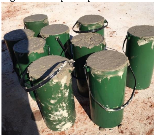
Figura 15: Corpos de prova moldados
