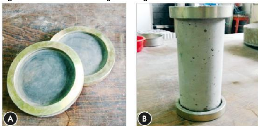
Figura 10: Processo de colagem da argamassa de enxofre
