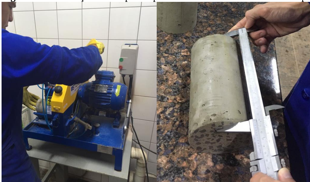
Figura 17: Retificação dos corpos de prova e coleta de medidas através do paquímetro
