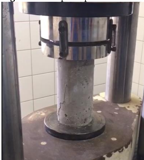
Figura 12: Corpo de prova centralizado na prensa
