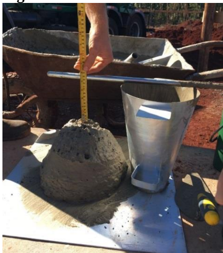
Figura 14: Teste de consistência do concreto
