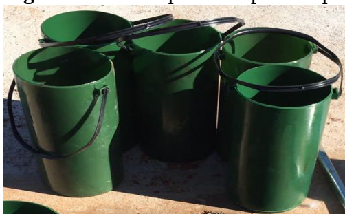
Figura 4: Moldes plásticos para corpo de prova
