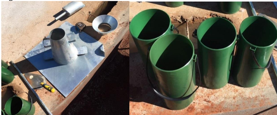
Figura 13: Instrumentos de teste e coleta do concreto
