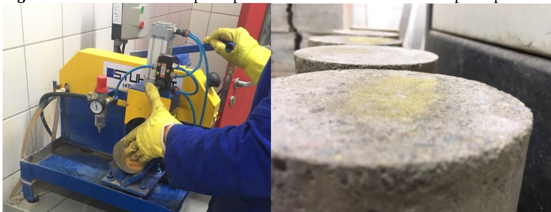
Figura 9: Retificadora de corpo de prova com disco diamantado e corpo de prova retificado
