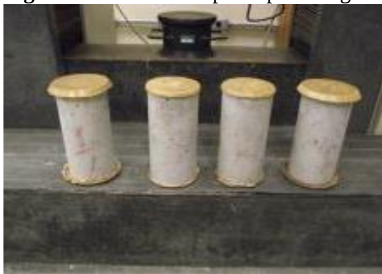
Figura 11: Base do corpo de prova regularizada após o capeamento
