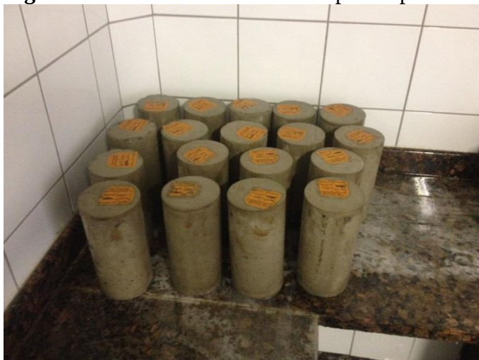
Figura 16: Processo de cura dos corpos de prova na câmara úmida
