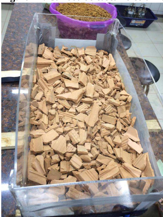
Figura 27: Camada de cascalho cerâmico compactado.
