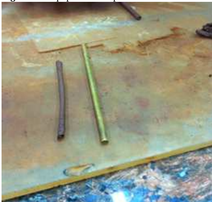
Figura 17: Equipamentos e procedimentos do ensaio de limite de plasticidade.
