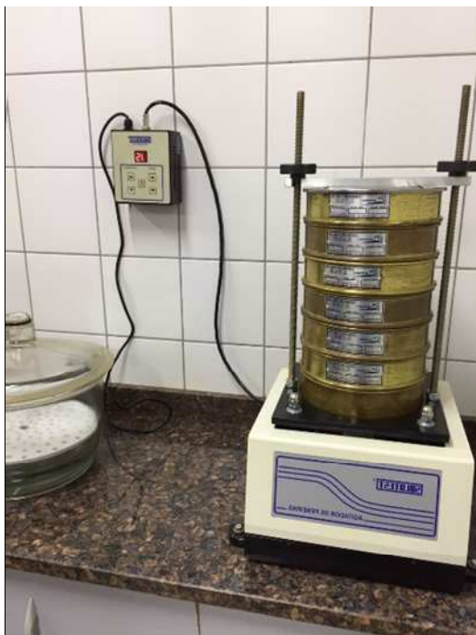
Figura 14: Equipamentos do ensaio de peneiramento.
