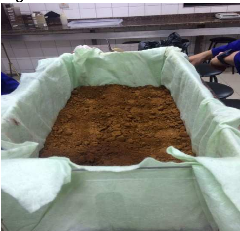
Figura 23: Camada de saibro sobre a manta geotêxtil.
