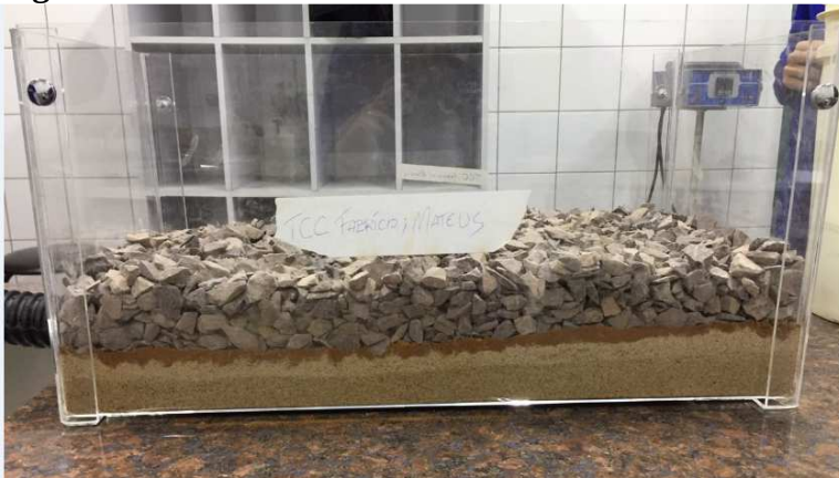
Figura 22: Camada de brita.
