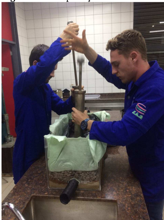
Figura 24: Compactação da camada.
