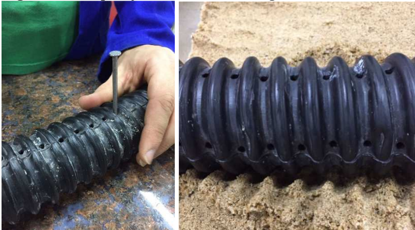
Figura 20: Preparação dos furos na mangueira.
