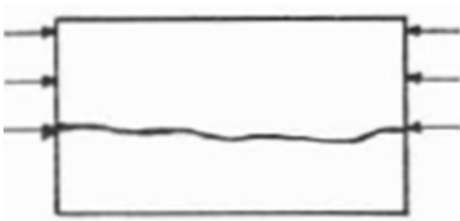
Figura 25: Fissura por compressão
