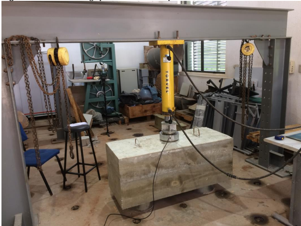
Figura 19: Célula de Carga posicionada entre o pistão e o bloco.
