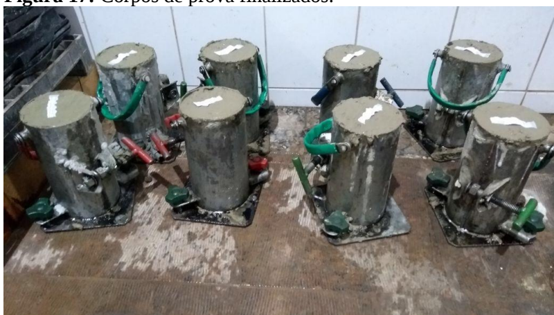
Figura 17: Corpos de prova finalizados.
