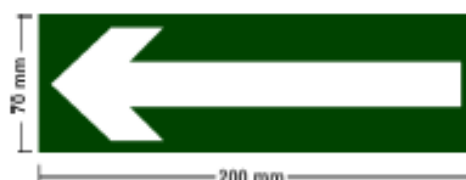
Figura 3 – Detalhe da sinalização tipo C-1
