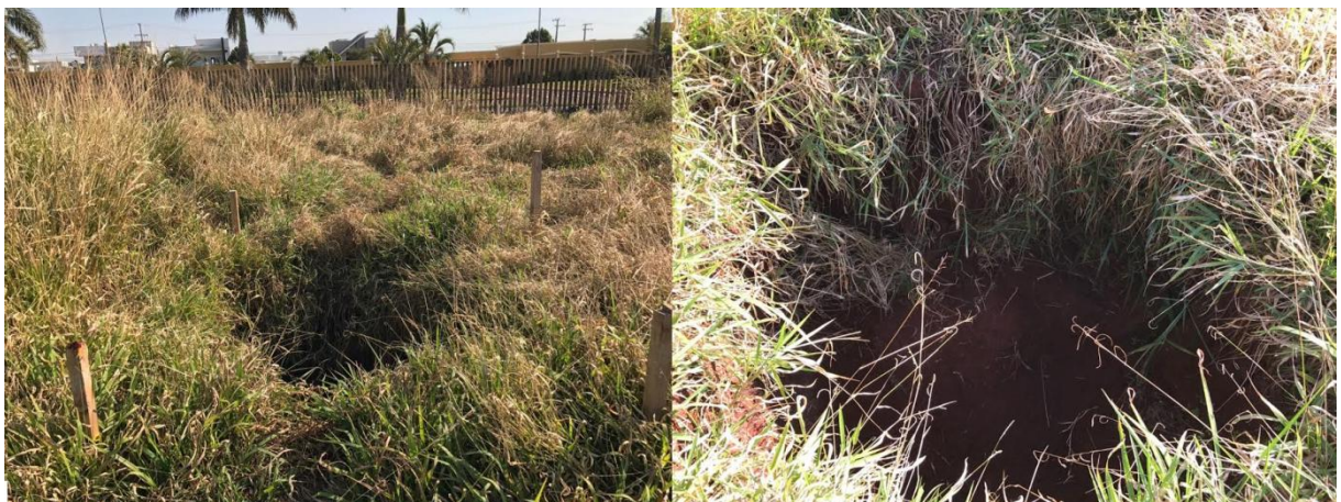
Figura 15 – Cava onde foram retiradas as amostras do primeiro metro de solo.
