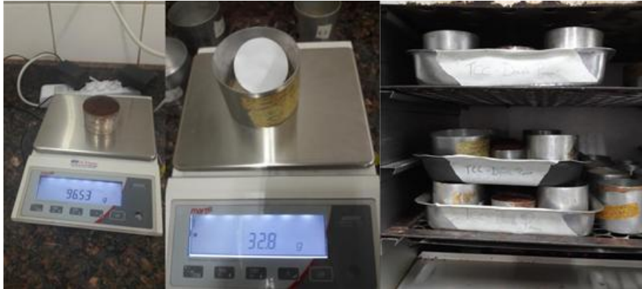
Figura 23 – Pesagem das amostras de solo e papéis filtros.
