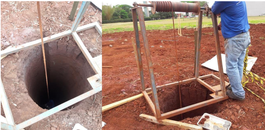
Figura 17 – Coleta das amostras de solo nas cotas de -2, -3, -4 e -5 m.
