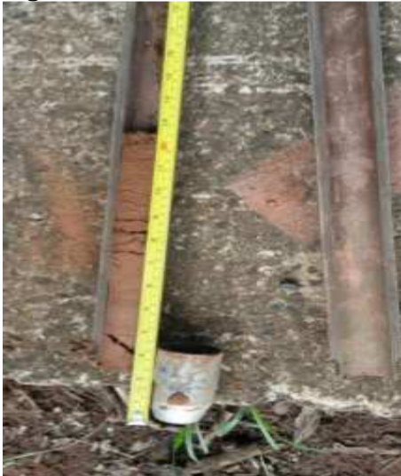
Figura 7 – Embuchamento no amostrador-padrão.
