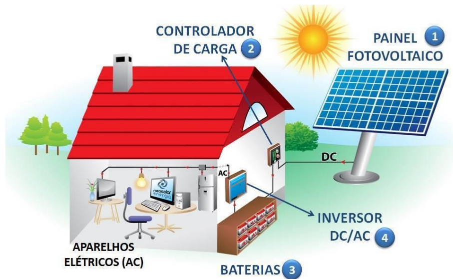
Figura 8: Sistema solar off grid
