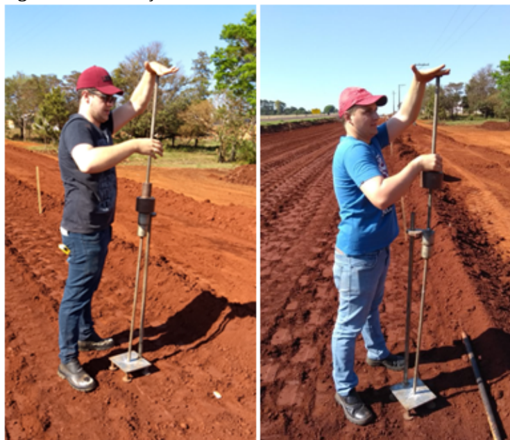
Figura 29 – Execução do Ensaio de CPD
