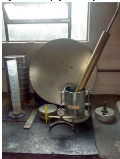
Figura 11 – Equipamentos para Execução do ISC
