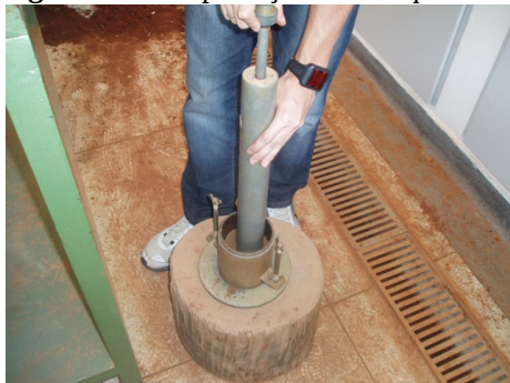
Figura 8 – Compactação com soquete
