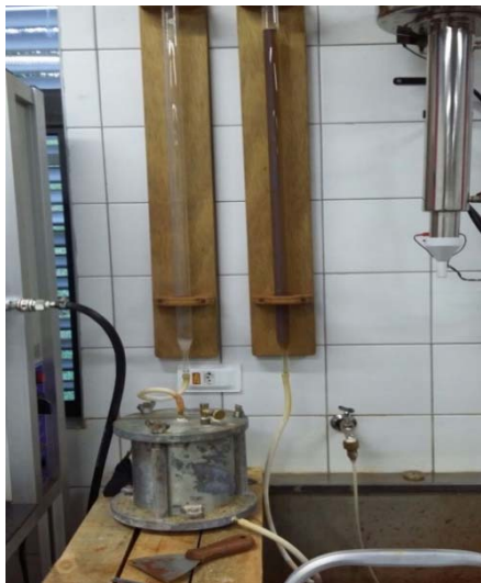
Figura 20: Permeâmetro conectado nas provetas com chorume.
