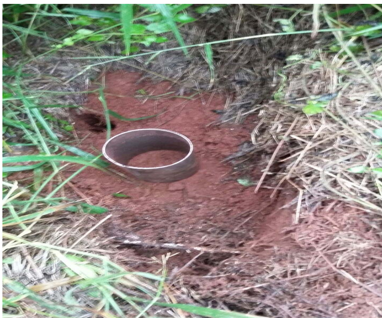
Figura 7: Camisa metálica sendo cravada no solo.
