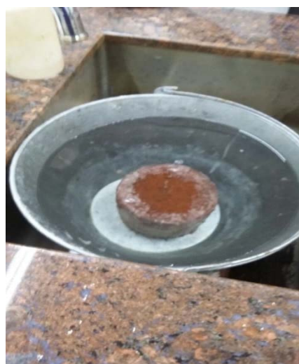
Figura 17: Corpo da prova submerso em água.
