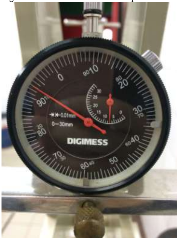
Figura 22 – Extensômetro fixado na prensa de adensamento.
