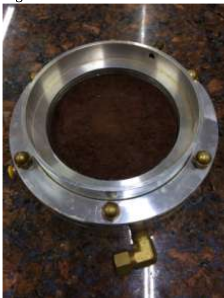
Figura 20 – célula com amostra.
