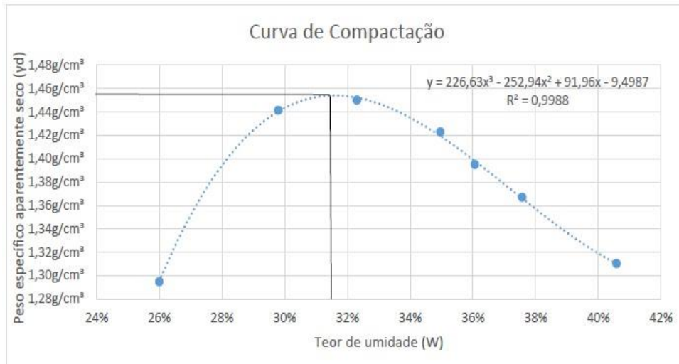
Figura 12 - Curva de compactação para Proctor Normal
