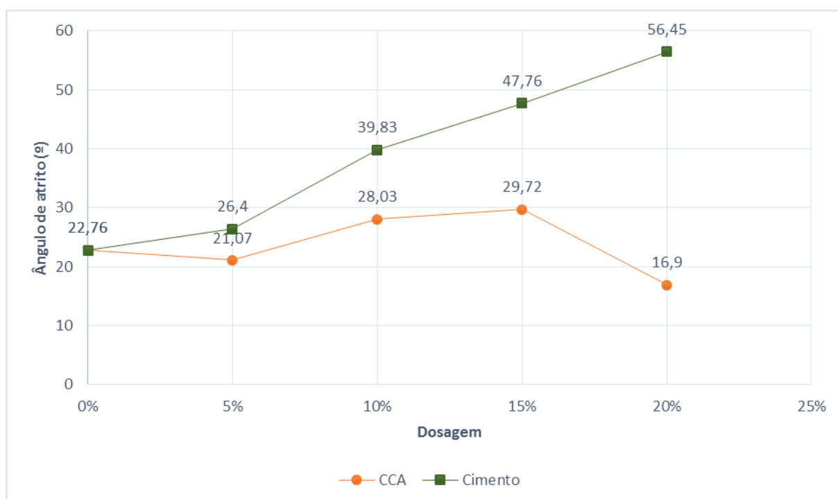
Figura 24: Ângulo de atrito entre amostras de cimento e cinza de casca de arroz
