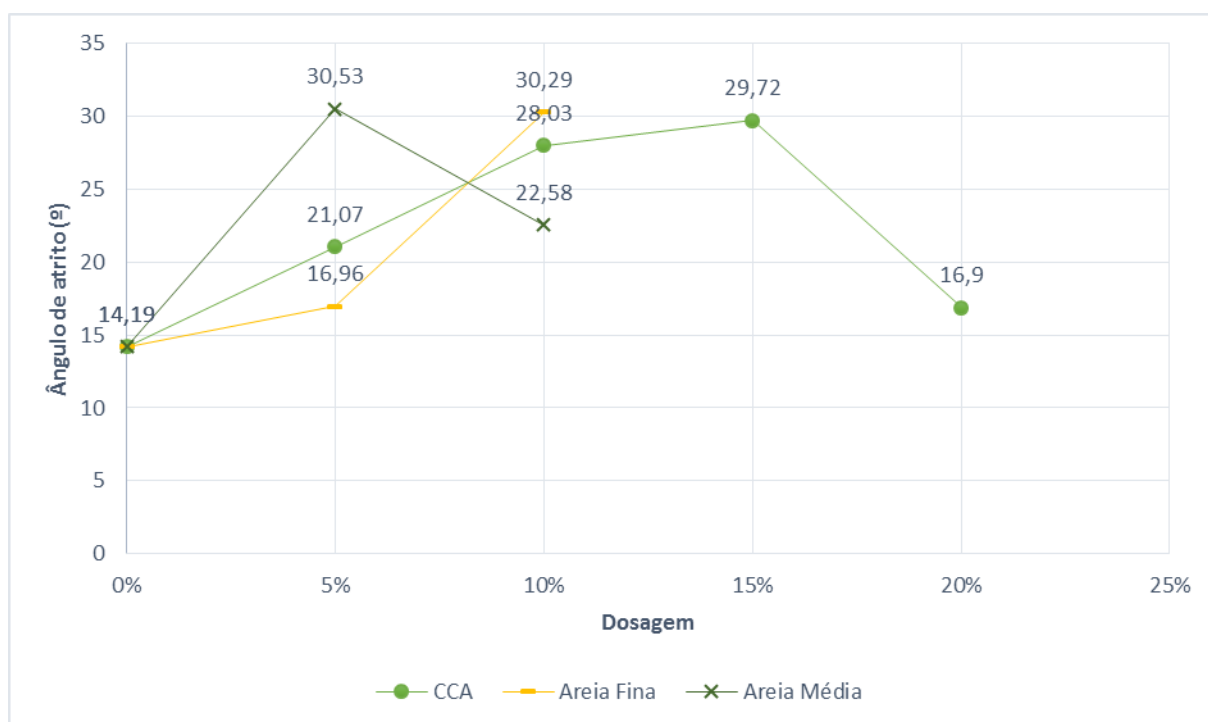
Figura 22: Ângulo de atrito entre amostras de areia e cinza de casca de arroz
