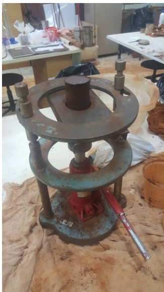
Figura 10: Macaco hidráulico fazendo a elevação do corpo de prova
