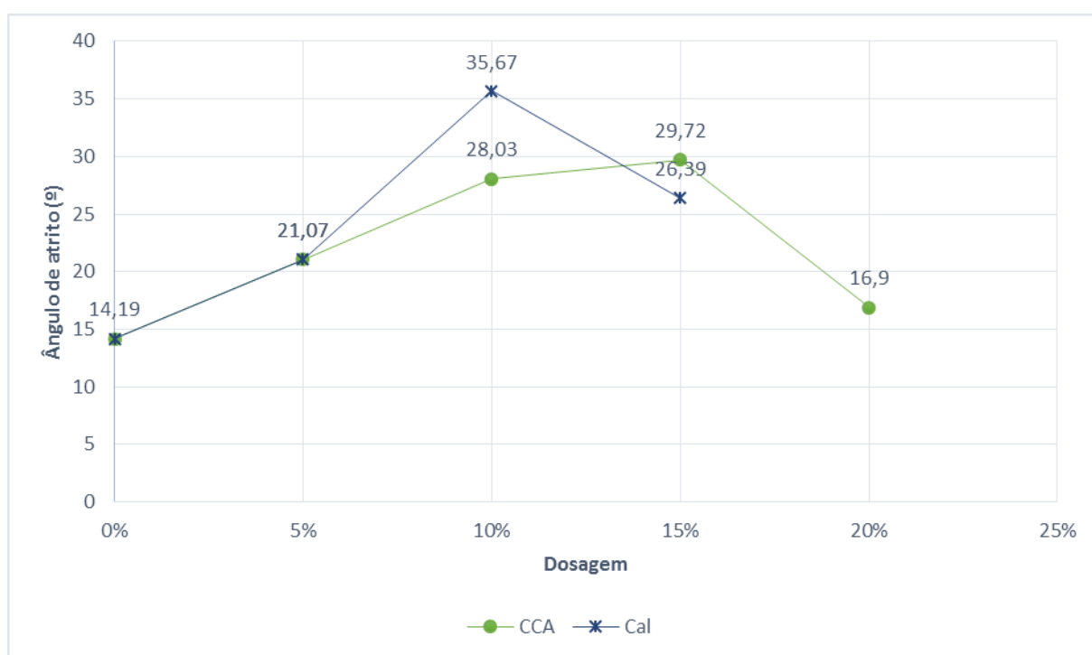
Figura 23: Ângulo de atrito entre amostras de cal e cinza de casca de arroz
