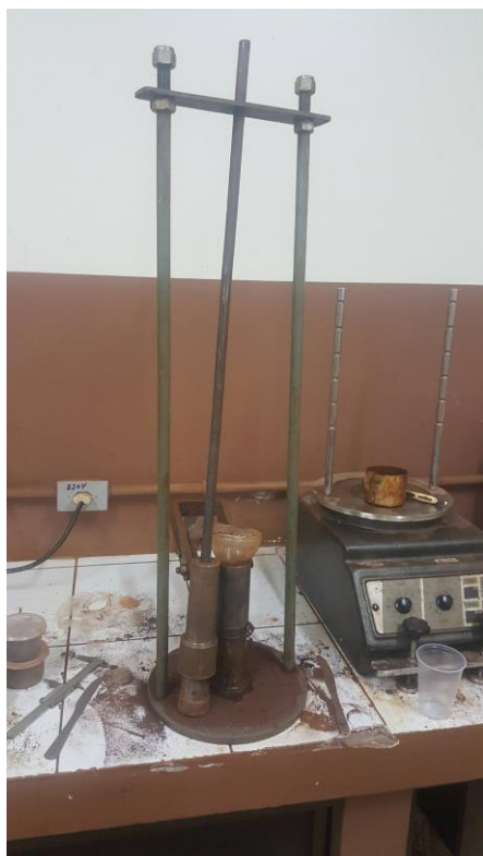
Figura 9 – Pisoteador usado para a compactação
