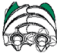
Figura 10 – Ciclo de trabalho de um compressor de parafuso.
