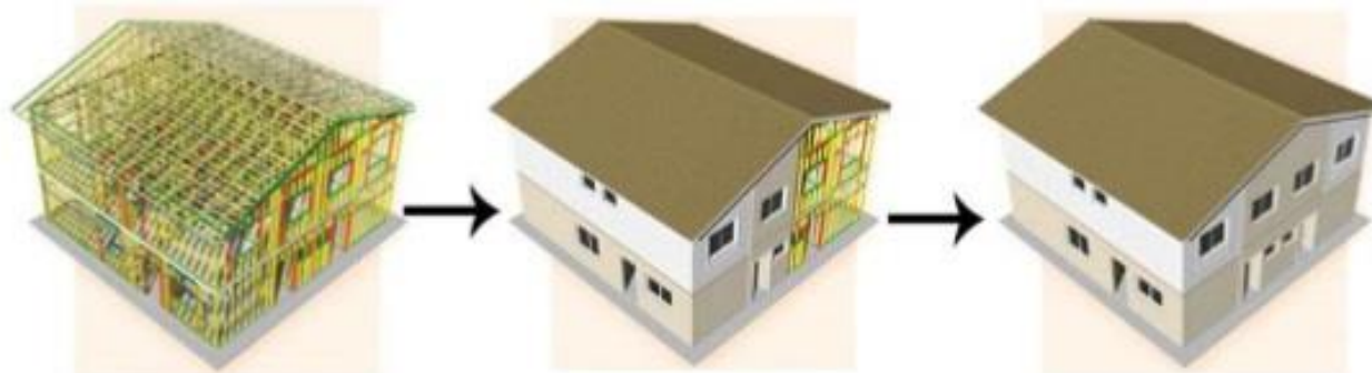
Figura 4: composição de uma edificação em steel frame:
