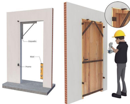
Figura 06 – Materiais necessários para o posicionamento da porta
