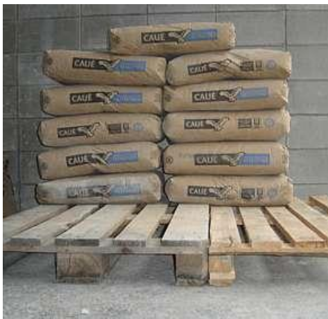
Figura 13 – Armazenagem correta de cimento
