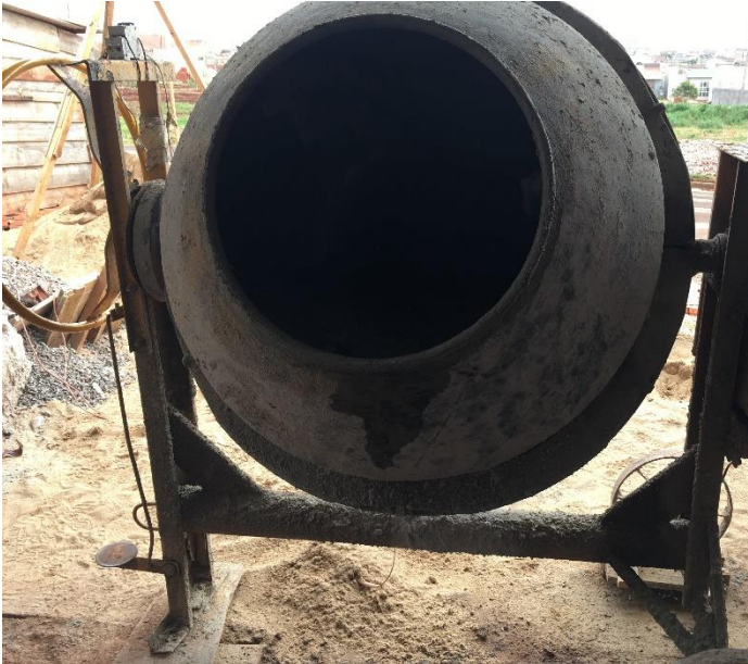
Figura 9 - Betoneira para preparo de argamassa.
