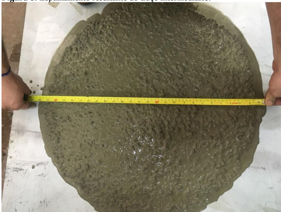
Figura 8: Espalhamento resultante do traço intermediário.
