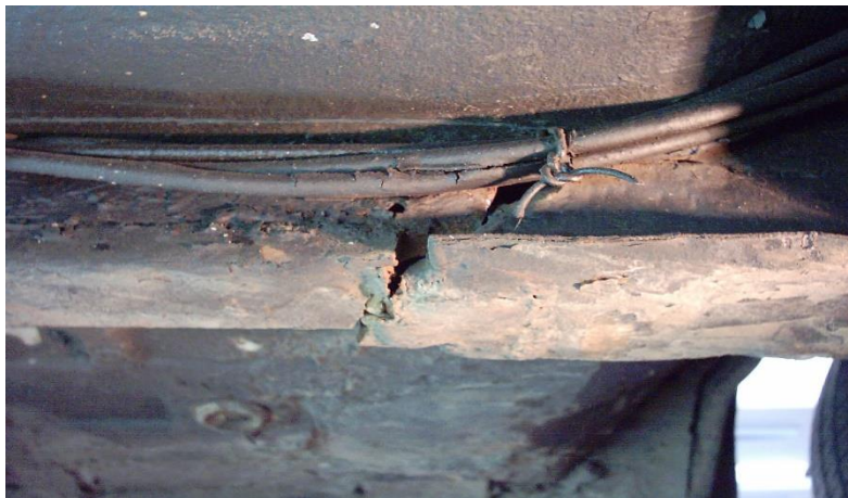
Figura 4 - Trinca apresentada em veículos pesados.
